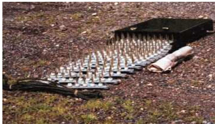
Lazy tongs portable road barrier Tutti i diritti riservati.
